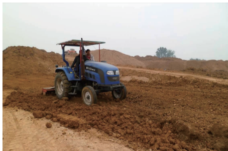
图1 现场试验旋耕机碎土
