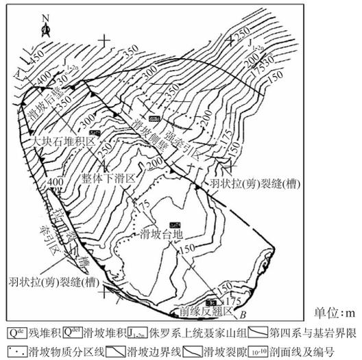
图 6 千将坪滑坡体地形与地质特征示意图<sup>[3]</sup>
